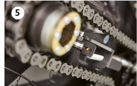
5 Stabile und breite Ölbürsten auf den Ketten für optimale Schmierung
