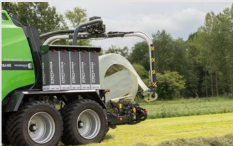
Der Wickelprozess startet mit dem Abdecken der Ballenschultern.
