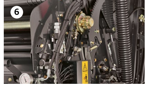
6 Proportionalventil für Dichteregelung von der Fahrerkabine aus
