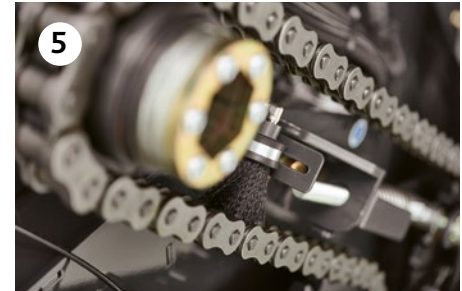
Stabile und breite Ölbürsten auf den Ketten für optimale Schmierung
