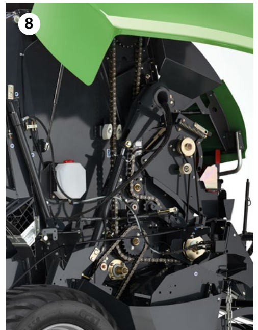
8 Robuster Antrieb mit hochwertigen IWIS-Ketten + 1¼-Zoll-20HB-Hauptantriebswelle mit Hartchromstiften
