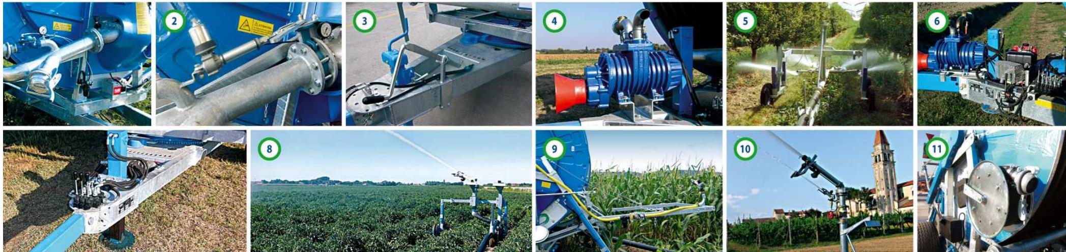
**ГИДРАУЛИЧЕСКАЯ ПОВОРОТНАЯ ПЛАТФОРМА, ДОМКРАТ И ТЕМЕННИК ТЕЛЕЖКИ/СТАБИЛИЗАТОРЫ** приводятся в действие щечным клапаном, работающим от гидравлики трактора (или двигателя, в привод механический) для вращения барабана, регулировки высоты крана и понижения/повышения тележки и стабилизаторов. Идеальны позиционирования больших машин в тяжелых рабочих условиях.
